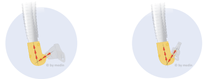
Şekil 8 - Miniflow ® nCPAP generator'un açısının ayarlanması
