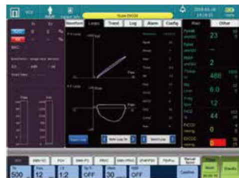
Medição em tempo real da pressão nas vias aéreas, vazão, volumes, complacência e resistência de respiração, oferecendo uma ferramenta intuitiva para detecção de vazamento, obstrução das vias aéreas e ajuste ideal dos parâmetros ventilados
